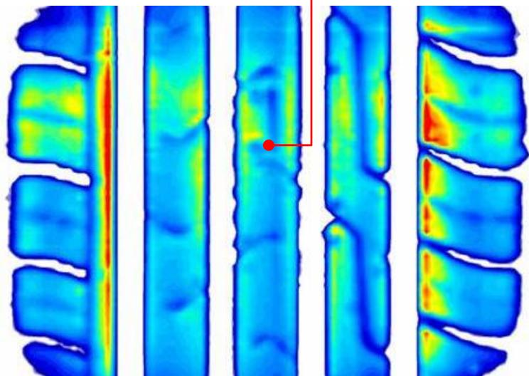
Новый профиль позволил увеличить наружный диаметр и ширину шины, благодаря чему удалось добиться оптимальной формы пятна контакта шины с дорогой и снизить коэффициент сопротивления качению.
