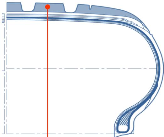
В протекторе шины использована новая резиновая смесь с большим содержанием «силики», которая также позволила повысить сцепные свойства шины на мокрой поверхности, одновременно снизив коэффициент сопротивления качению
