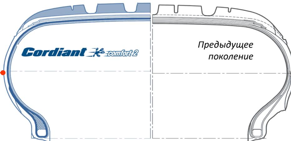
Амортизационные свойства обеспечивает более эластичная боковина и новый облегченный материал корда каркаса.
