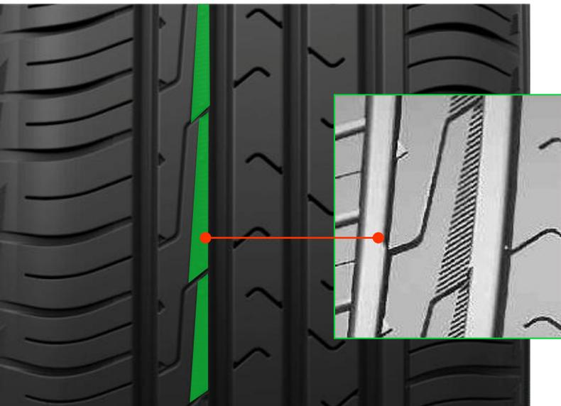
Насечка «Антишум», образованная диагональными микроканавками, находящимися на среднем продольном ребре шины и в зонах окончания рисунка, создает дополнительные микроповерхности, обтекаемые воздушным потоком, снижая звуковой резонанс.
