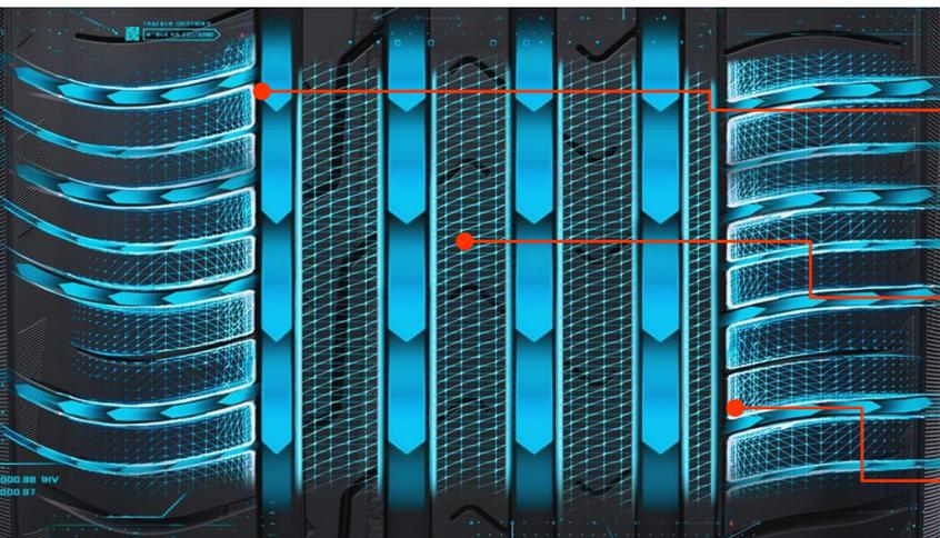
• Дуговые дренажные канавки различной ширины отводят воду из внутренней части протектора
